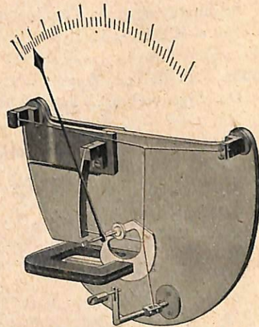
Bild 246. Hitzdrahtmeßgerät mit Wirbelstromdämpfung
